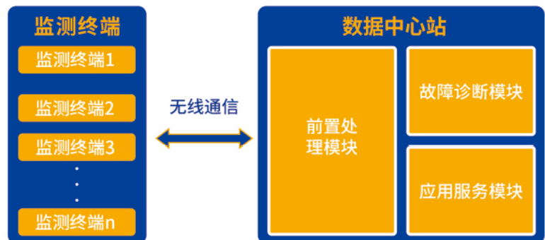
图3 分布式故障监测装置构成图
